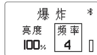
\* 爆炸模式下，需通过Trigger按钮触发光效，短按一次Trigger按钮触发一次光效。
