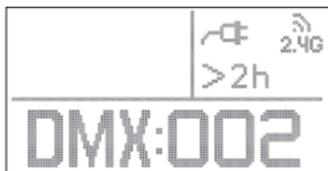
进入DMX模式后，可通过旋钮进行通道的增加及减小操作，顺时针增加，逆时针减小。短按MENU键保存选择。
