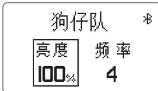
短按Frequency键选择频率调整，如下图，再调节旋钮改变灯的频率值，频率调节范围为1~10, R (随机)。
