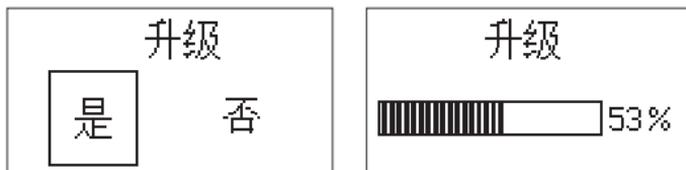
\* 使用U盘进行升级时，必须使用存储格式为FAT16或FAT32的U盘，使用其它格式的U盘，无法完成升级操作，且主界面上会显示格式错误，并自动返回主界面。
