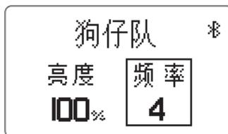
\* 光效模式下，若突然断电，机器再次上电后，OLED屏显示断电前的界面并根据界面的数值作响应。
